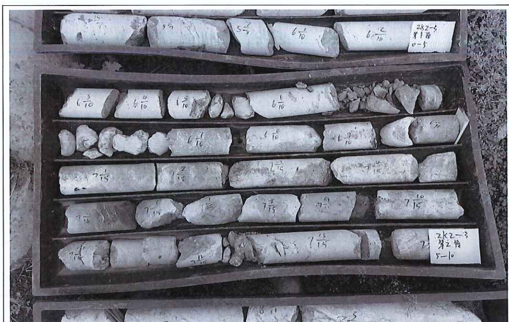
图 4-5 ZK2-3 揭露泥质白云岩夹层
